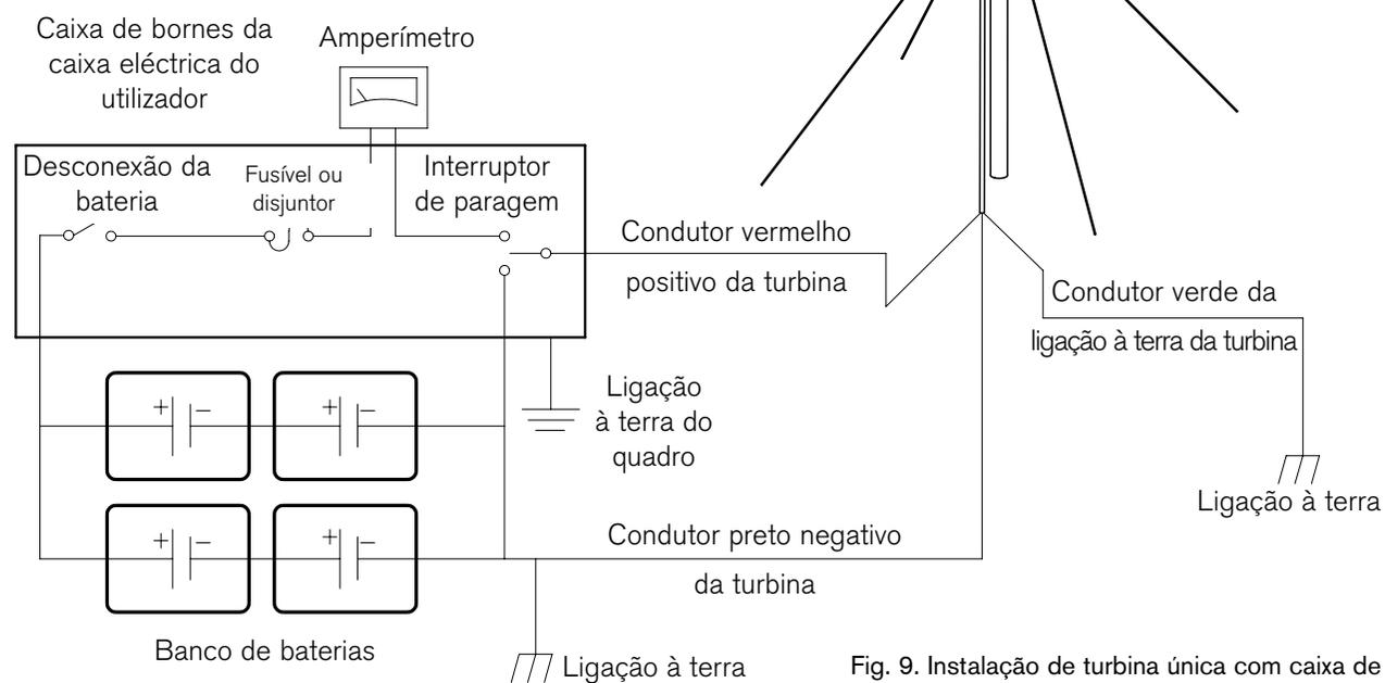
Fig. 9. Instalação de turbina única com caixa de bornes na parte superior da Torre
