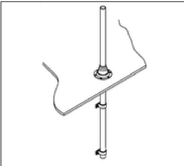
Fig. 7. Kit para montagem no telhado
