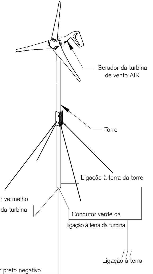
Fig. 8. Instalação com turbina única
