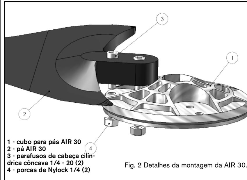
Fig. 2 Detalhes da montagem da AIR 30.
