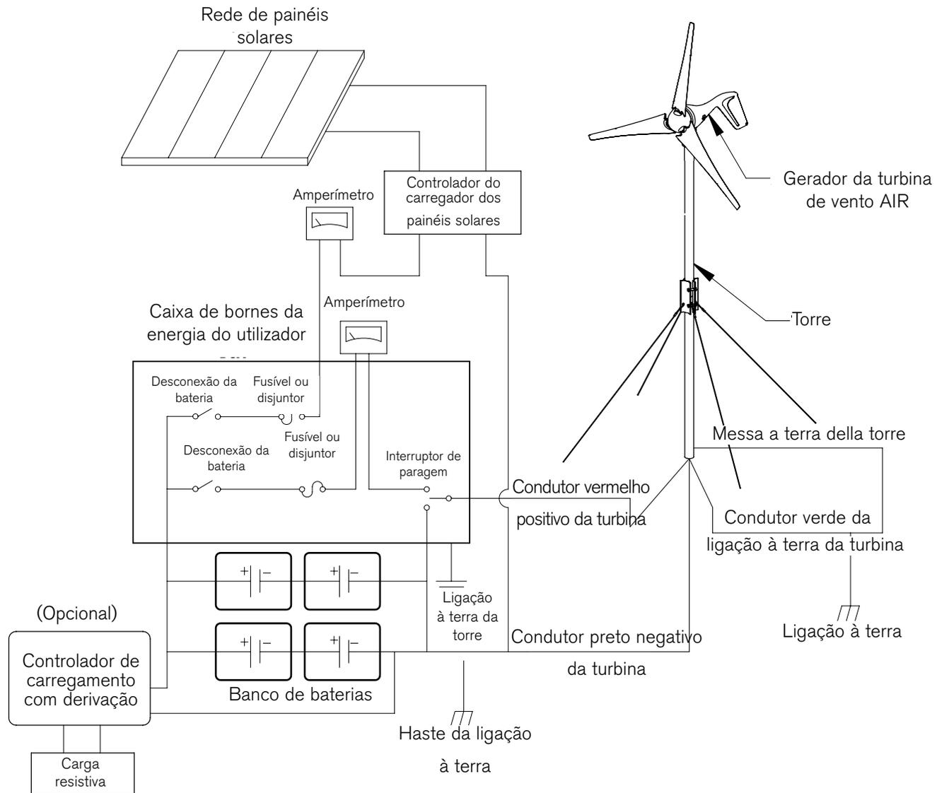
Fig. 10. Sistema ibrido con moduli fotovoltaici
