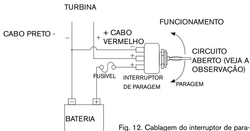
Fig. 12. Cablagem do interruptor de paragem
