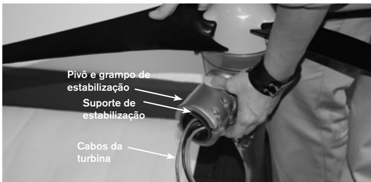
1.) Coloque o suporte de estabilização no conjunto ponta do pivô de estabilização/grampo.
