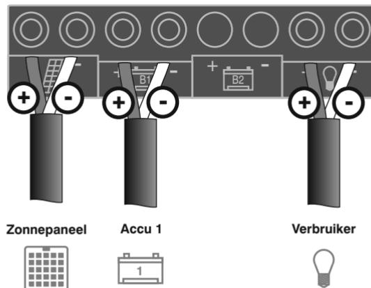
Zodra accu 1 aangeklemd wordt, start de regelaar. Tijdens de startfase voert de regelaar een zelftest uit en herkent hij de systeemspanning (let hierbij op het display).
