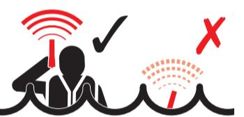
Das S10 muss im aktivierte Zustand immer über Wasser gehalten werden, da seine Reichweite bei direktem Kontakt mit Wasser erheblich eingeschränkt ist.
