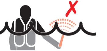
Para una transmisión óptima, el S10 debe mantenerse vertical una vez activado.
