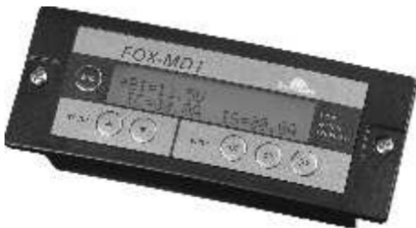
Wanneer u het Multi Display FOX-MD1 op de FOX-220 aansluit, kunt u comfortabel alle spanningen, stromen en laadtoestanden op het grote verlichte display en gedeeltelijk als grafiek aflezen. Bovendien kunt u verschillende parameters veranderen zoals bijv. eindspanningen, maximale ontlading en nog veel meer. Wanneer u deze luxe een keer hebt leren kennen, wilt u de FOX-MD1 niet meer missen.
